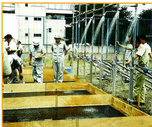
試験体への散水状況
