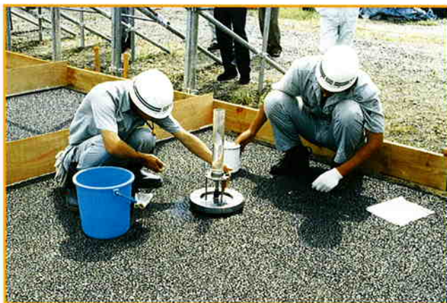
現場透水試験の状況
